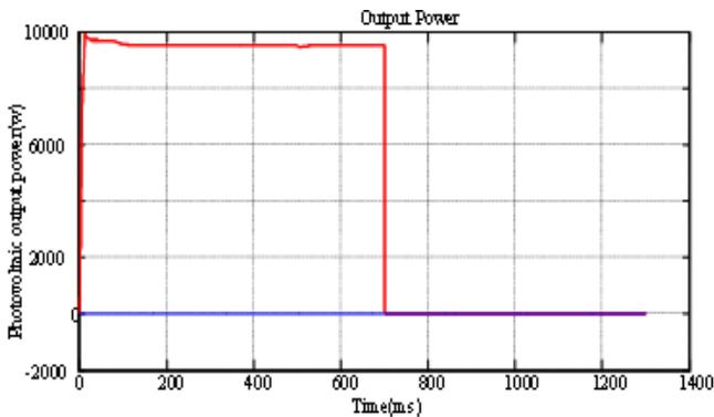
Fig. 9. (d) Output power under sunlight existing and night conditions
